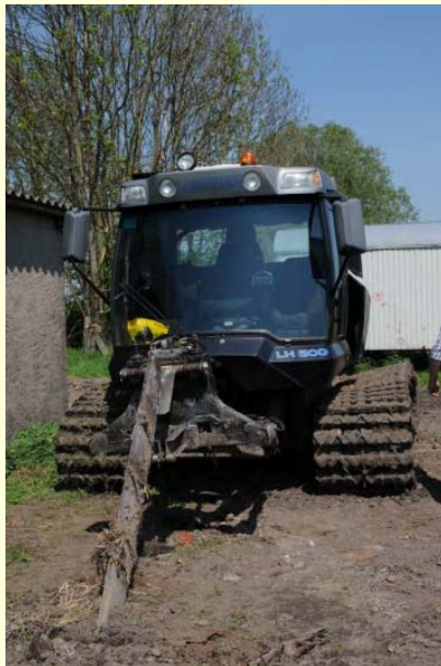
Umgebaute Mohrraupe, Aufnahmen der Dränrohre (V.Rowinsky ; 2013)
